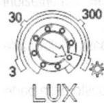
Regola il livello di luminosità ambiente per l'attivazione del rilevatore di presenza.
